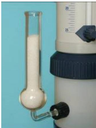
Kalziumchlorid-Röhrchen mit Kunststoffbeschichtung für trockene Atmosphäre im Vorratsgefäß (Lieferung ohne Kalziumchlorid)
