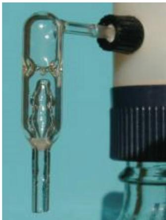
Rückschlagventil aus Borosilikatglas mit Kunststoffbeschichtung, verhindert das Austreten von Gasen und Gerüchen.
